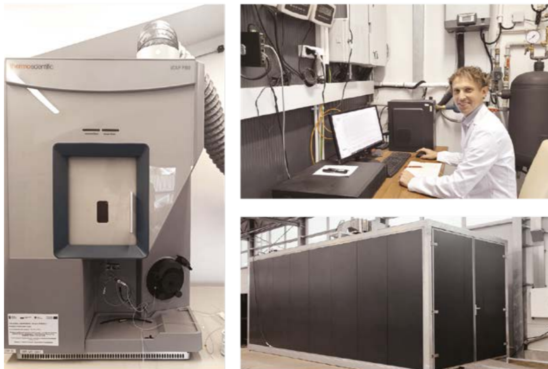
SPEKTOMETR Wykorzystywany do analizy metali ciężkich oraz szerokiego zakresu pierwiastków we wszystkich dodatkach okryw i podłożach ogrodniczych.
